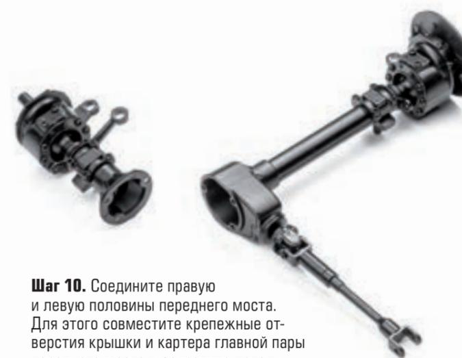
**Шаг 10.** Соедините правую и левую половины переднего моста. Для этого совместите крепежные отверстия крышки и картера главной пары переднего моста и закрепите детали при помощи трех винтов 2,3×5 (ИМ).
