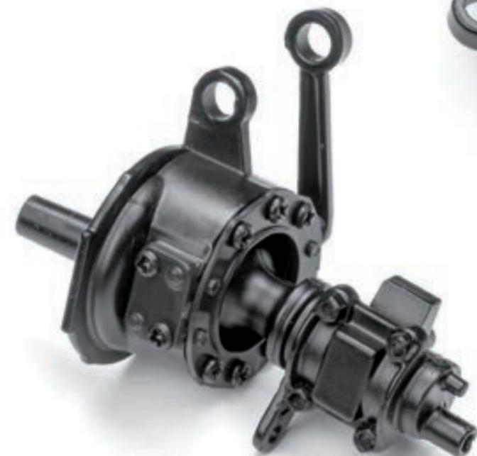
**Шаг 8.** Установите и закрепите нижнюю накладку на поворотном кулаке двумя винтами 1,7×4 (СМ).
