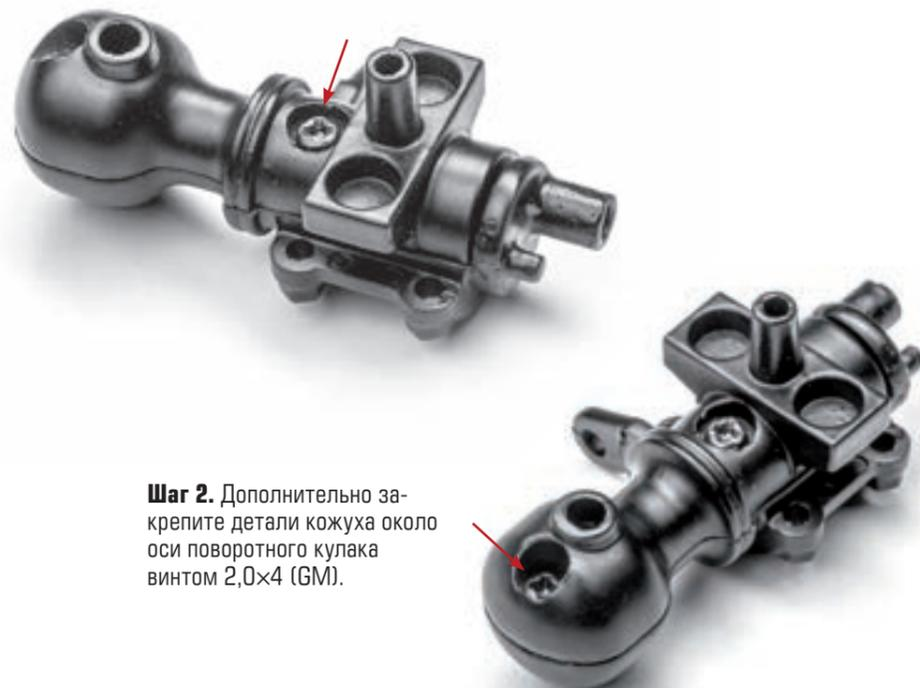
**Шаг 2.** Дополнительно закрепите детали кожуха около оси поворотного кулака винтом 2,0×4 (GM).
