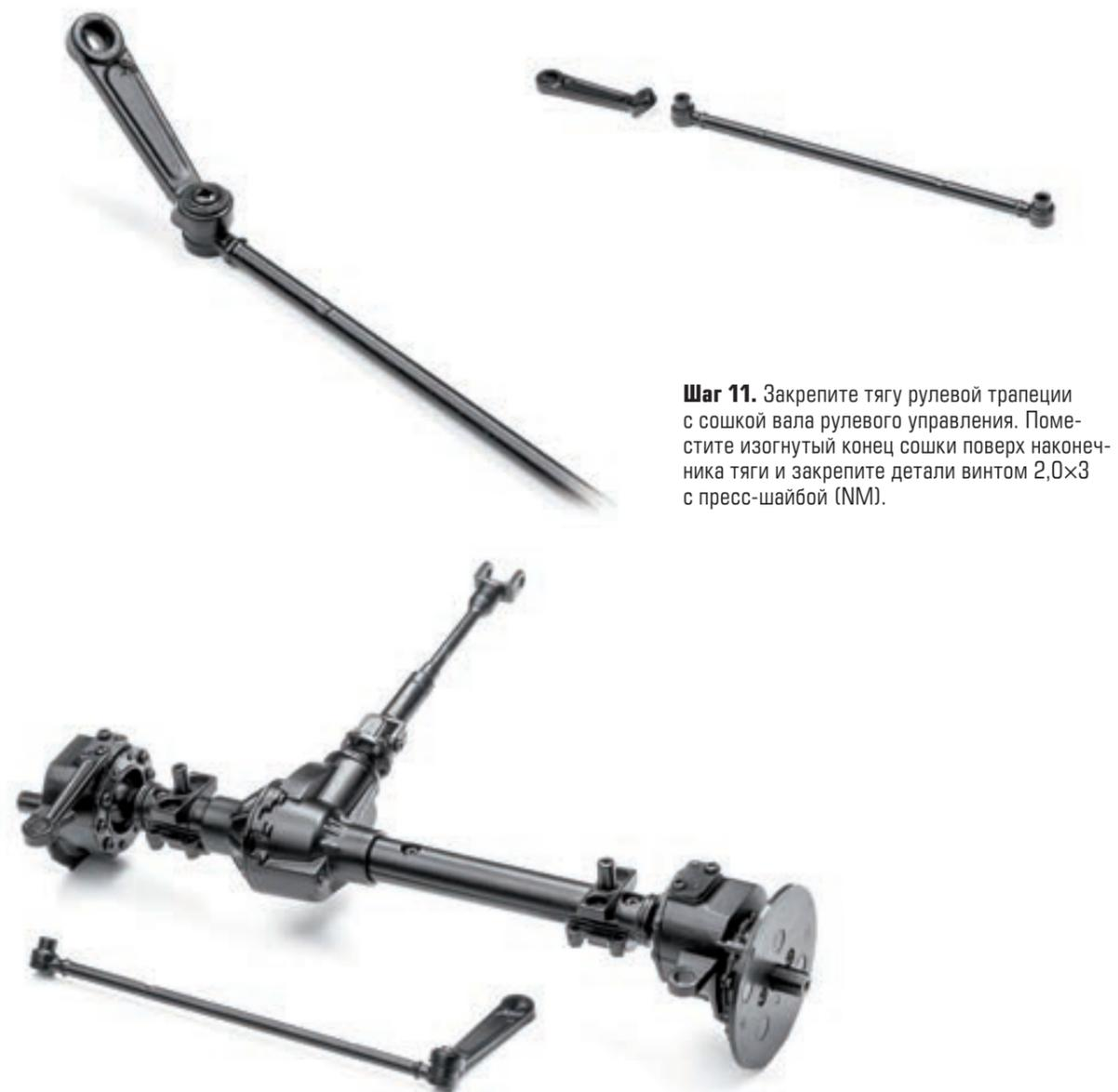
**Шаг 11.** Закрепите тягу рулевой трапеции с сошкой вала рулевого управления. Поместите изогнутый конец сошки поверх наконечника тяги и закрепите детали винтом 2,0×3 с пресс-шайбой (NM).
