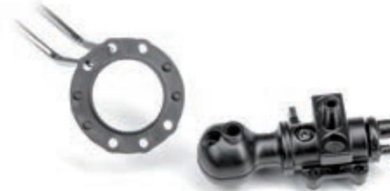
**Шаг 4.** Поверх шаровой опоры поворотного кулака установите корпус поворотного кулака. При правильной установке рычаг рулевой тяги должен находиться в передней части моста, а кронштейн крепления рессоры (на кожухе полуоси) располагаться сверху. Закрепите корпус поворотного кулака на шаровой опоре винтом 2,3×21 (MM). Поворотный кулак должен оставаться подвижным относительно кожуха полуоси.
